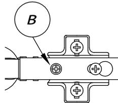
а - регулировка расстояния между дверью и корпусом
