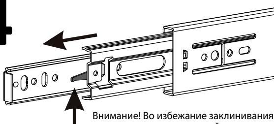
! В отдельных случаях, наклейки для направляющих могут не совпадать. Нужно придерживаться горизонтали, на которой уже есть наклейки и установить направляющие вручную.
