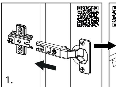
Плечо петли надвигается на ответную планку и фиксируется винтом
