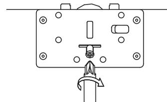
5. Сдвинуть доводчик задней двери таким образом, чтобы она полностью не перекрывалась передней дверью. Зафиксируйте доводчик в направляющей.
