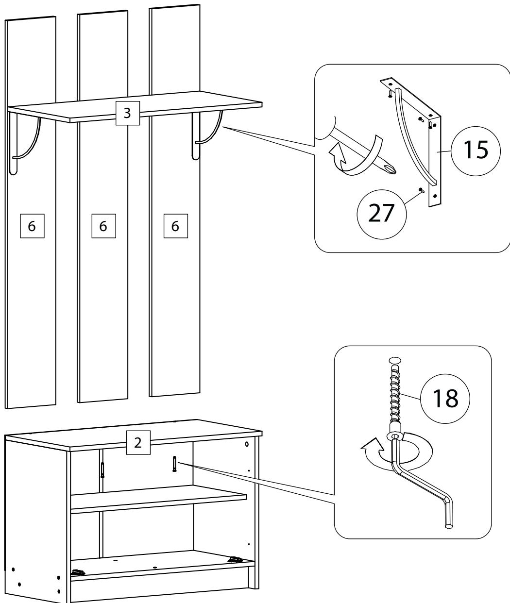
С помощью линейки и карандаша на стене отмечаем место, где будет крепиться вешалка. Отдельно намечаем места, где надо сверлить отверстия под крепления. Просверливаем три отверстия в стене при помощи дреши. Молотком загоняем дюбеля в отверстия. В дюбеля забиваем гвозди. Вешаем зеркало. Ставим тумбочку ровно под вешалку.
