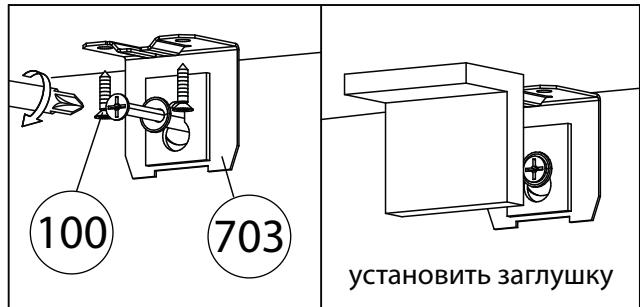
**ВАЖНО!** При глубине шкафа менее 500 мм возможно опрокидывание изделия, необходимо крепить изделие к стене при помощи мебельного навеса. Материалы стен различаются, поэтому крепежные средства не прилагаются. Используйте крепежные средства, подходящие для материала стен в Вашем доме. Для выбора крепежных средств обратитесь в специализированный магазин.
