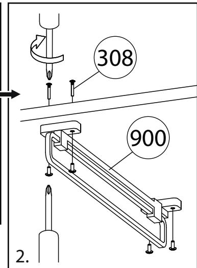
При глубине шкафа менее 500 мм устанавливаются выдвижные кронштейны вместо штанги (1 штанга=1 кронштейн)
