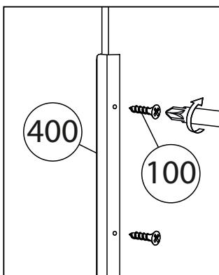
При необходимости модули стягиваются между собой межсекционными стяжками. Предварительно в соприкасающихся боковинах под стяжки просверливаются сквозные отверстия диаметром 5мм.
