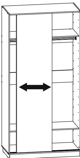
Регулировочным винтом на роликах выровняйте зазор между дверью и боковой шкафом.
