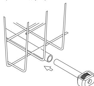
c. Крепежный цилиндр вставьте в пластиковую втулку, так что бы плоская часть крепежного цилиндра была расположена со стороны регулировочного колеса.
