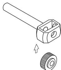
b. Вставьте пластиковую втулку узкой частью внутрь полой металлической трубы, приваренной к дну корзины.
