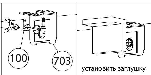
**ВАЖНО!** При глубине шкафа менее 500 мм возможно опрокидывание изделия, необходимо крепить изделие к стене при помощи мебельного навеса. Материалы стен различаются, поэтому крепежные средства не прилагаются. Используйте крепежные средства, подходящие для материала стен в Вашем доме. Для выбора крепежных средств обратитесь в специализированный магазин.
