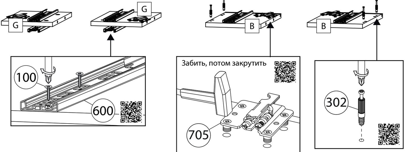
При установке направляющих с двух сторон не рекомендуется фиксировать саморезами в смежные отверстия
