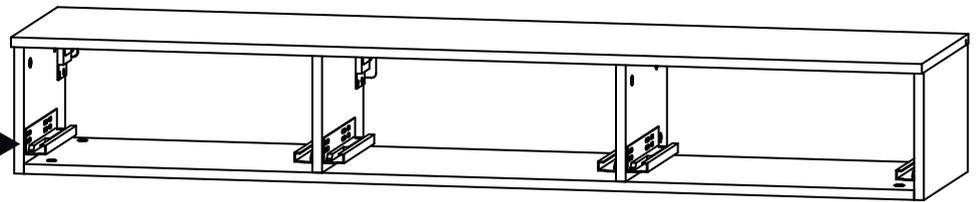
При установке направляющих с двух сторон не рекомендуется фиксировать саморезами в смежные отверстия
