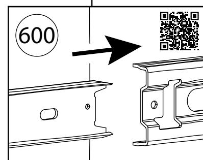
Выдвиньте подвижные элементы направляющих, вставьте ящик и задвиньте до щелчка. Крючки направляющих должны войти в зацепление с отверстиями в задней стенке ящика.
