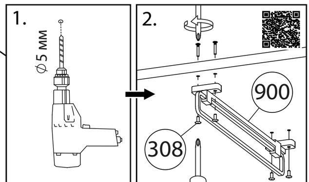
При глубине шкафа менее 500 мм вместо штанги устанавливаются выдвижные кронштейны (1 штанга = 1 кронштейн).
