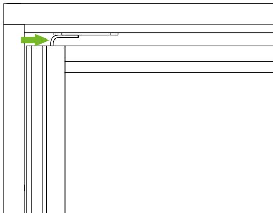
Для регулировки необходимо ослабить сборочный саморез и выдвинуть или задвинуть ось вращения.
