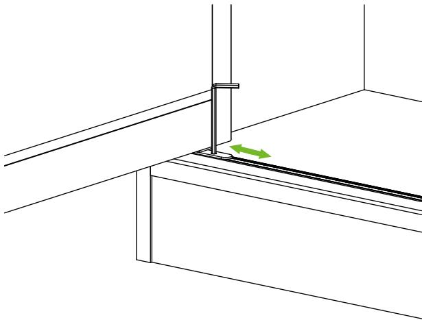
**9** Как ограничитель двери в системе используются магнитные защелки. Устанавливаются на боковую, Верхнюю или нижнюю панель шкафа.
