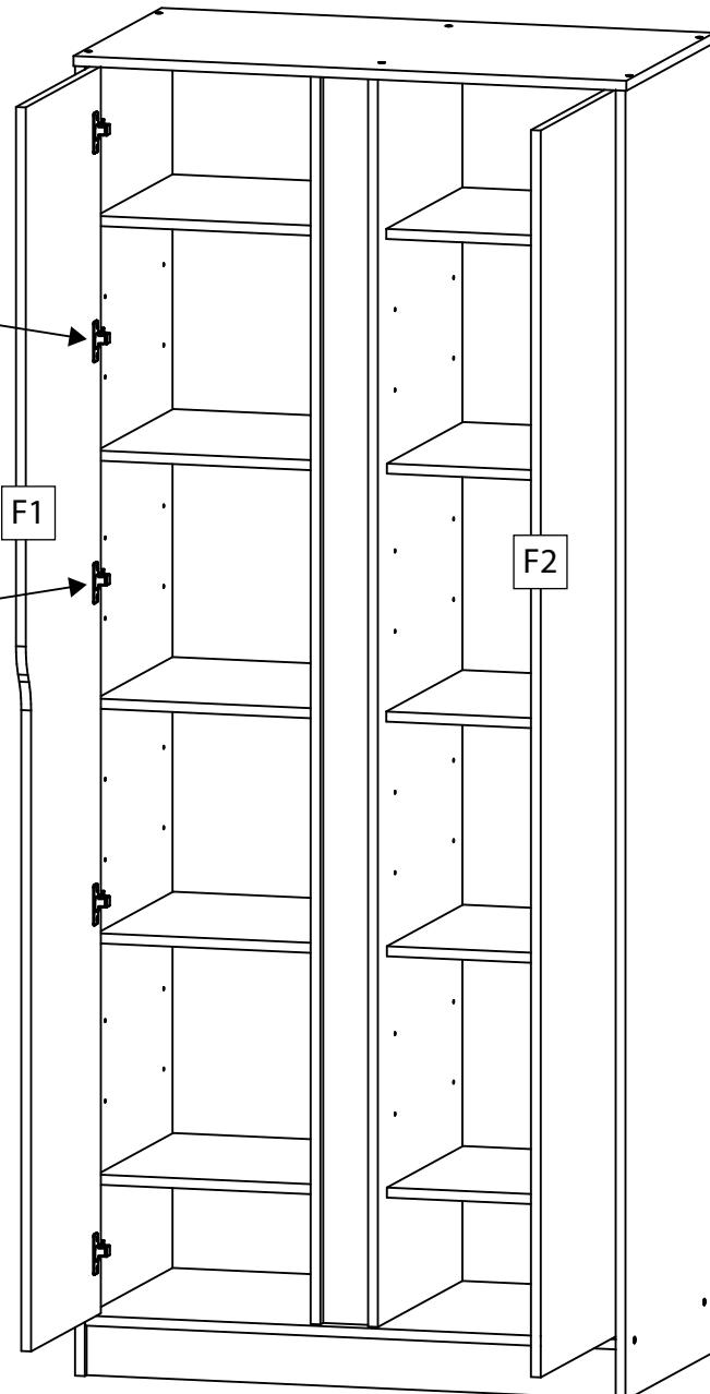
При необходимости модули стягиваются между собой межсекционными стяжками. Предварительно в соприкасающихся боковинах под стяжки просверливаются сквозные отверстия диаметром 5мм.
