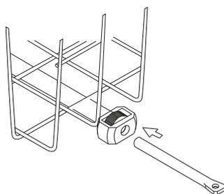
d. С помощью болта, вставленного в отверстие на плоской части крепежного цилиндра, и гайки привинтите корзину к ответной части направляющих.
