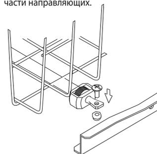
4. Установите корзину на направляющие, которые установлены на боковые стенки модуля шкафа.
