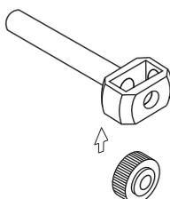
b. Вставьте пластиковую втулку узкой частью внутрь полой металлической трубки, приваренной к дну корзины.
