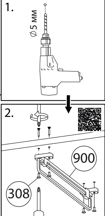
При глубине шкафа менее 500 мм вместо штанги устанавливаются выдвижные кронштейны (1 штанга = 1 кронштейн).
