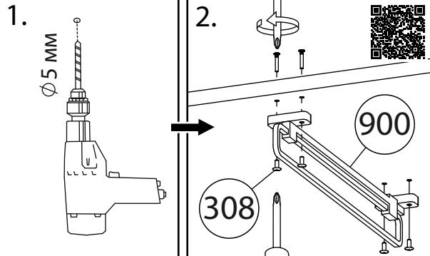
При глубине шкафа менее 500 мм вместо штанги устанавливаются выдвижные кронштейны (1 штанга = 1 кронштейн).
