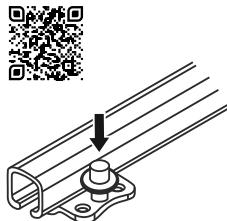
В комплект направляющих скрытого монтажа частично-го выдвижения не входят фиксаторы. Функцию фикса-тора выполняет штырь направляющих.
