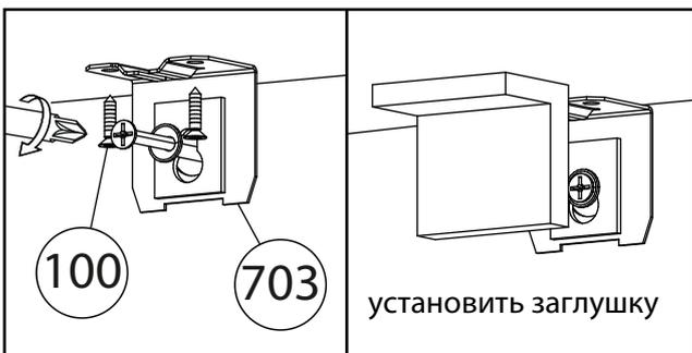
**ВАЖНО!** При глубине шкафа менее 500 мм возможно опрокидывание изделия, необходимо крепить изделие к стене при помощи мебельного навеса. Материалы стен различаются, поэтому крепежные средства не прилегают. Используйте крепежные средства, подходящие для материала стен в Вашем доме. Для выбора крепежных средств обратитесь в специализированный магазин.
