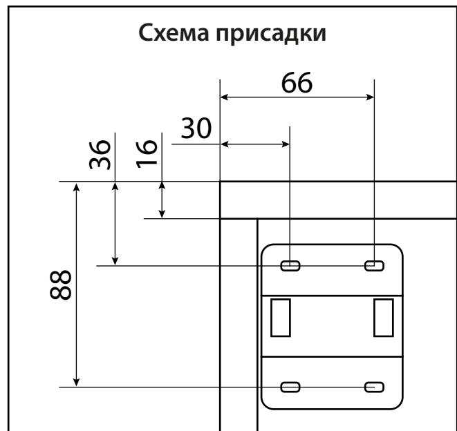
Закрепите планки для навешивания (704) на стене, используя схему присадки. Материалы стен различаются, поэтому используйте крепежные средства, подходящие для материала стен в вашем доме. Для выбора крепежных средств обратитесь в специализированный магазин. Навесьте изделие на планки, отрегулируйте навесы (705), установите декоративные заглушки (706) на навесы.
