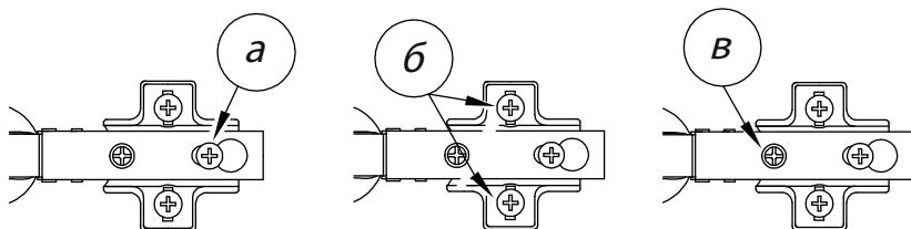
**a** - регулировка расстояния между дверью и корпусом
