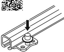
В комплект направляющих скрытого монтажа частично-го выдвижения не входят фиксаторы. Функцию фиксатора выполняет штырь направляющих.
