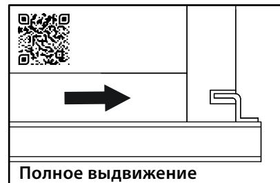
Выдвиньте подвижные элементы направляющих, вставьте ящик. Крючки направляющих должны войти в зацепление с отверстиями в задней стенке ящика. Опуская ящик вниз, нужно насадить стенки боковыми отверстиями на штыри направляющих. После установки ящика на направляющие отрегулируйте зазоры по высоте, вращая шайбу с накаткой.
