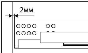
В отдельных случаях, наметки для направляющих могут не совпадать. Поэтому нужно придерживаться горизонтали, на которой уже есть наметки и установить направляющие вручную.
