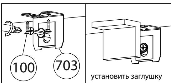
Опрокидывание мебели может привести к серьёзным телесным повреждениям. Рекомендуем зафиксировать изделие к стене при помощи мебельного навеса (703) для предотвращения его опрокидывания. Материалы стен различаются, поэтому крепежные средства не прилагаются. Используйте крепежные средства, подходящие для материала стен в Вашем доме. Для выбора крепежных средств обратитесь в специализированный магазин.
