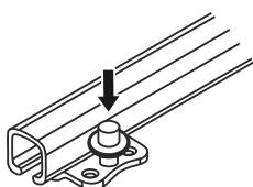
В комплект направляющих скрытого монтажа частичного выдвижения не входят фиксаторы. Функцию фиксатора выполняет штырь направляющих.
