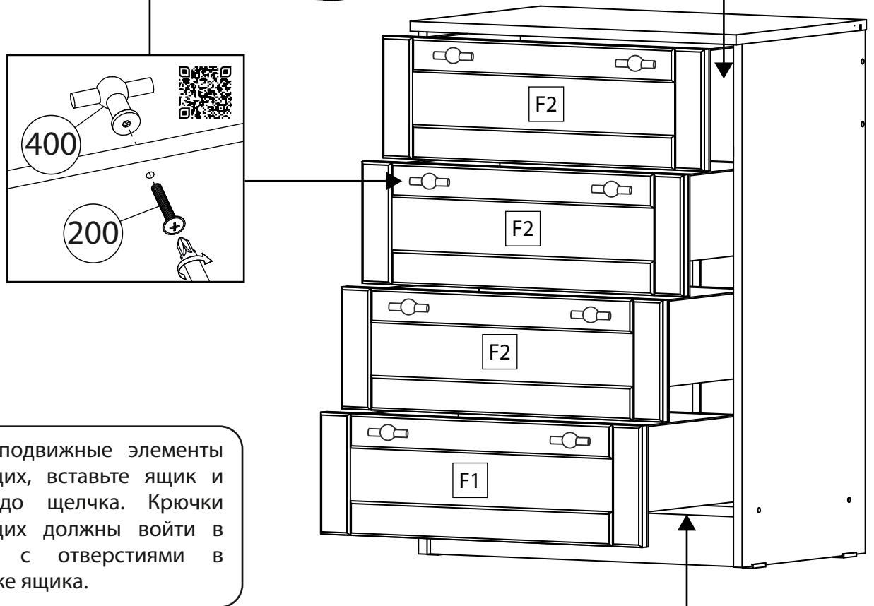
Выдвиньте подвижные элементы направляющих, вставьте ящик и задвиньте до щелчка. Крючки направляющих должны войти в зацепление с отверстиями в задней стенке ящика.
