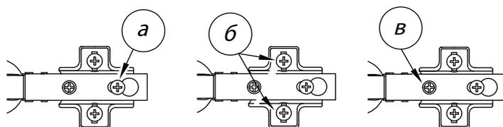
а - регулировка расстояния между дверью и корпусом
