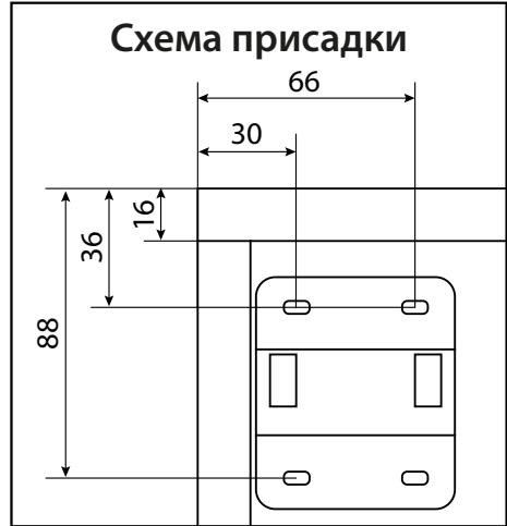
Закрепите планки для навешивания (704) на стене, используя схему присадки. Материалы стен различаются, поэтому используйте крепежные средства, подходящие для материала стен в вашем доме. Для выбора крепежных средств обратитесь в специализированный магазин. Навесьте изделие на планки, отрегулируйте навесы (705), установите декоративные заглушки (706) на навесы.
