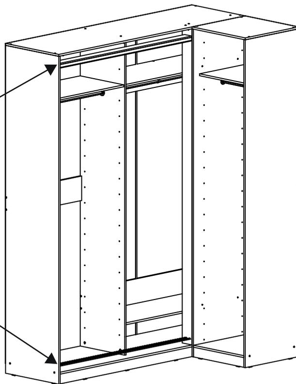
Закрепить верхнюю направляющую саморезами. Верхняя направляющая ставится заподлицо с боковыми стенками шкафа, нижняя направляющая ставится на дно с отступом 18 мм от края.
