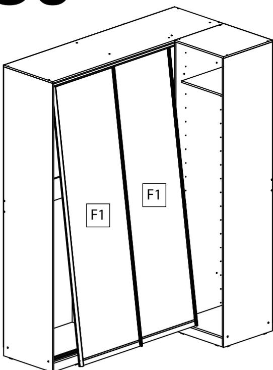
Завести верх двери-купе в верхнюю направляющую, после чего поджать нижние ролики и завести низ двери. Отпустить нижние ролики. Проконтролировать попадание обоих нижних роликов в паз нижнего рельса. Аналогично вставить остальные двери. Проверить ход дверей-купе. При необходимости сдвинуть нижний рельс, чтобы достичь строгой вертикальности дверей и ровности их хода. С помощью ключа отрегулировать натяжение нижних роликов дверей.
