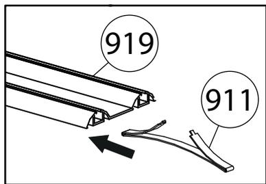
Задвинуть стопора в нижнюю направляющую до её установки
