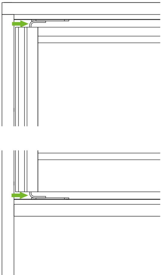
Для регулировки необходимо ослабить сборочный саморез и выдвинуть или задвинуть ось вращения.
