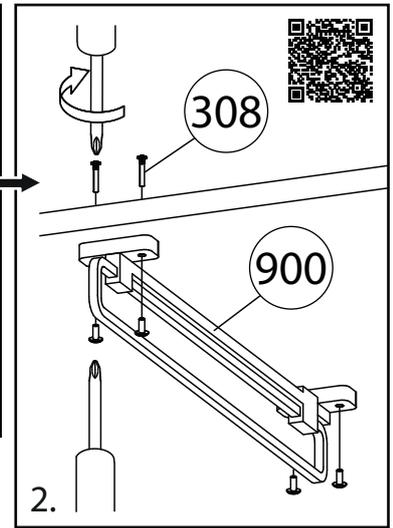
При глубине шкафа менее 600 мм устанавливаются выдвижные кронштейны вместо штанги (1 штанга=1 кронштейн)
