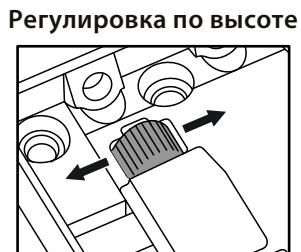
В комплект направляющих скрытого монтажа входят: фиксаторы левый и правый, направляющие левая и правая. Фиксаторы устанавливаются на дно ящика, а направляющие на боковины корпуса. Разъединение производится путем нажатия на рычаги фиксаторов. Если направляющие крепятся на одной боковине с двух сторон, то саморезы необходимо крепить в разные отверстия направляющей. Для регулировки выкатных ящиков по высоте необходимо повернуть регулировочное колесо на фиксаторе (см. рисунок).
