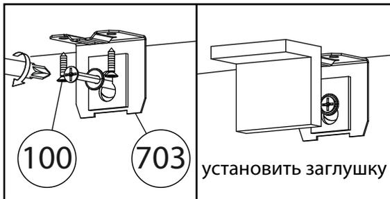
**ВАЖНО!** При глубине шкафа менее 500 мм возможно опрокидывание изделия, необходимо крепить изделие к стене при помощи мебельного навеса. Материалы стен различаются, поэтому крепежные средства не прилагаются. Используйте крепежные средства, подходящие для материала стен в Вашем доме. Для выбора крепежных средств обратитесь в специализированный магазин.
