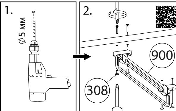
При глубине шкафа менее 500 мм вместо штанги устанавливаются выдвижные кронштейны (1 штанга = 1 кронштейн).
