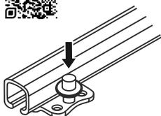
В комплект направляющих скрытого монтажа частичного выдвижения не входят фиксаторы. Функцию фиксатора выполняет штырь направляющих.
