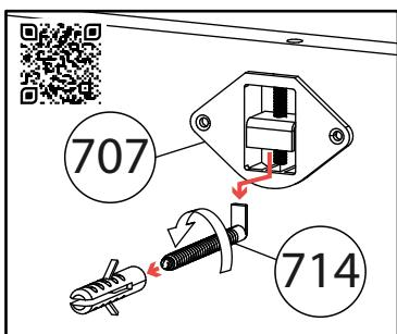
С помощью линейки и карандаша на стене отмечаем место, где будет крепиться изделие. Отдельно намечаем места, где надо сверлить отверстия под крепления. Просверливаем отверстия в стене при помощи дреши. Молотком загоняем дюбеля в отверстия. В дюбеля заворачиваем крюки. Вешаем изделие.
