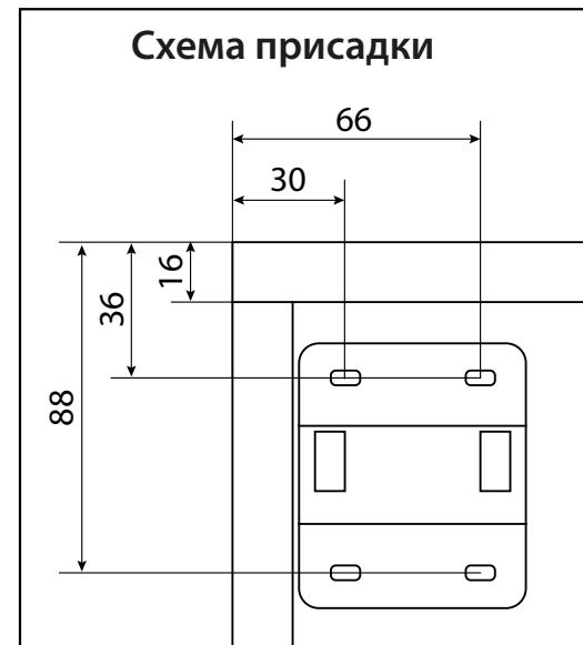
Закрепите планки для навешивания (704) на стене, используя схему присадки. Материалы стен различаются, поэтому используйте крепежные средства, подходящие для материала стен в вашем доме. Для выбора крепежных средств обратитесь в специализированный магазин. Навесьте изделие на планки, отрегулируйте навесы (705), установите декоративные заглушки (706) на навесы.
