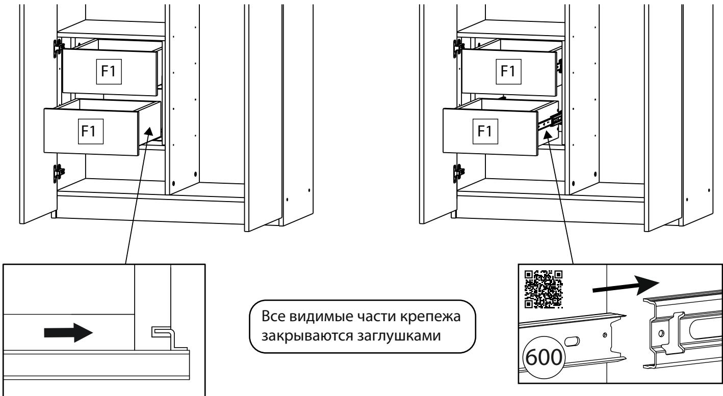
Выдвиньте подвижные элементы направляющих, вставьте ящик и задвиньте до щелчка. Крючки направляющих должны войти в зацепление с отверстиями в задней стенке ящика.
