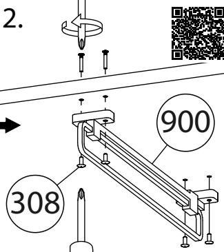
При глубине шкафа менее 500 мм вместо штанги устанавливаются выдвижные кронштейны (1 штанга = 1 кронштейн).
