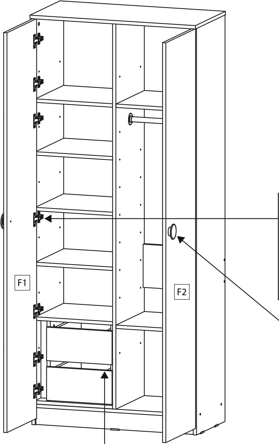
Блок ящиков установить согласно схеме ниже
