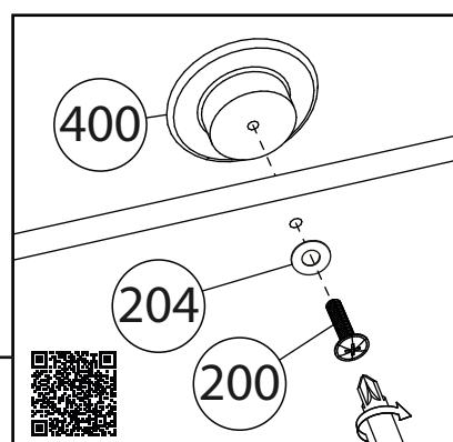
При необходимости модули стягиваются между собой межсекционными стяжками. Предварительно в соприкасающихся боковинах под стяжки просверливаются сквозные отверстия диаметром 5 мм.
