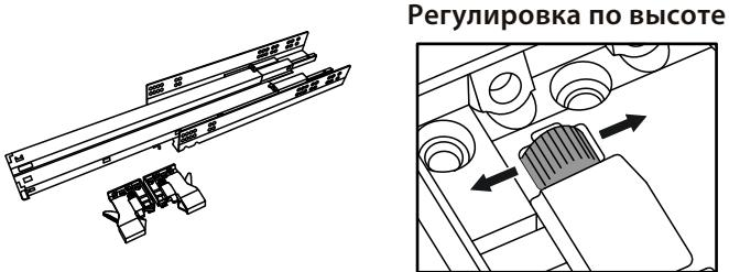
В комплект направляющих скрытого монтажа входят: фиксаторы левый и правый, направляющие левая и правая. Фиксаторы устанавливаются на дно ящика, а направляющие на боковины корпуса. Разъединение производится путем нажатия на рычаги фиксаторов. Если направляющие крепятся на одной боковине с двух сторон, то саморезы необходимо крепить в разные отверстия направляющей. Для регулировки выкатных ящиков по высоте необходимо повернуть регулировочное колесо на фиксаторе (см. рисунок).
