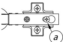
**б** - регулировка положения двери по вертикали
