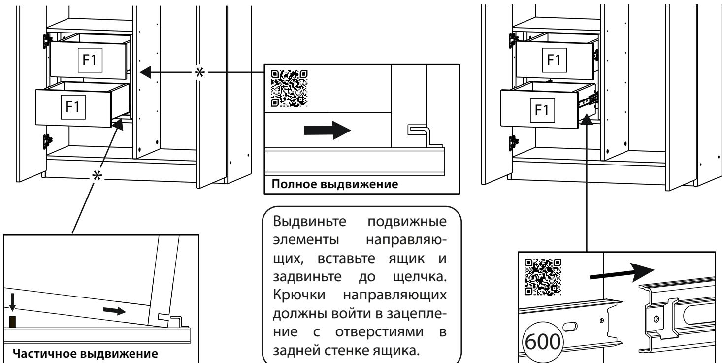
Выдвиньте подвижные элементы направляющих, вставьте ящик. Крючки направляющих должны войти в зацепление с отверстиями в задней стенке ящика. Опуская ящик вниз, нужно насадить стенки боковыми отверстиями на штыри направляющих. После установки ящика на направляющие отрегулируйте зазоры по высоте, вращая шайбу с накаткой.
