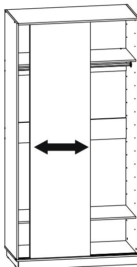
Регулировочным винтом на роликах выровняйте зазор между дверью и боковой шкафной панелью.
