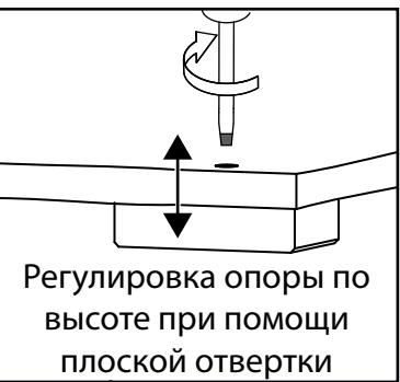
Регулировка опоры по
