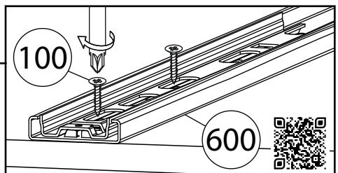
При установке направляющих с двух сторон не рекомендуется фиксировать саморезами в смежные отверстия
