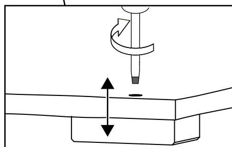
Регулировка опоры по высоте
