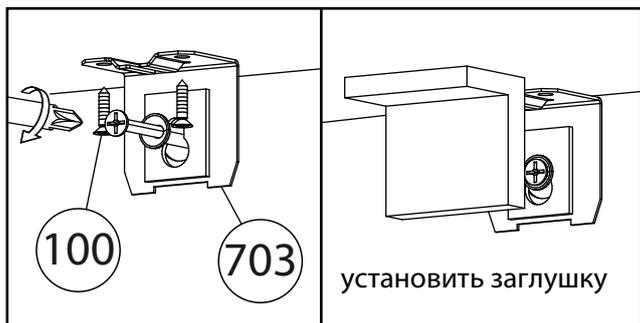
**ВАЖНО!** При глубине шкафа менее 500 мм возможно опрокидывание изделия, необходимо крепить изделие к стене при помощи мебельного навеса. Материалы стен различаются, поэтому крепежные средства не прилегают. Используйте крепежные средства, подходящие для материала стен в Вашем доме. Для выбора крепежных средств обратитесь в специализированный магазин.
