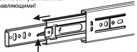
В комплект направляющих скрытого монтажа входят: фиксаторы левый и правый, направляющие левая и правая. Фиксаторы устанавливаются на дно ящика, а направляющие на боковины корпуса. Разъединение производится путем нажатия на рычаги фиксаторов. Если направляющие крепятся на одной боковине с двух сторон, то саморезы необходимо крепить в разные отверстия направляющей. Для регулировки выкатных ящиков по высоте необходимо повернуть регулировочное колесо на фиксаторе (см. рисунок).
