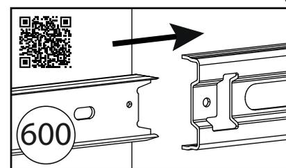
Выдвиньте подвижные элементы направляющих, вставьте ящик и задвиньте до щелчка. Крючки направляющих должны войти в зацепление с отверстиями в задней стенке ящика.
