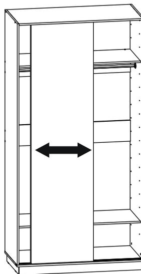
Регулировочным винтом на роликах выровняйте зазор между дверью и боковиной шкафа.
