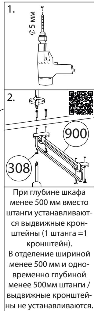
При необходимости модули стягиваются между собой межсекционными стяжками. Предварительно в соприкасающихся боковинах под стяжки просверливаются сквозные отверстия диаметром 5мм.
