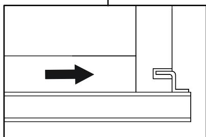
Выдвиньте подвижные элементы направляющих, вставьте ящик и задвиньте до щелка. Крючки направляющих должны войти в зацепление с отверстиями в задней стенке ящика.
