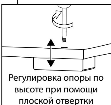
Регулировка опоры по высоте при помощи плоской отвертки
