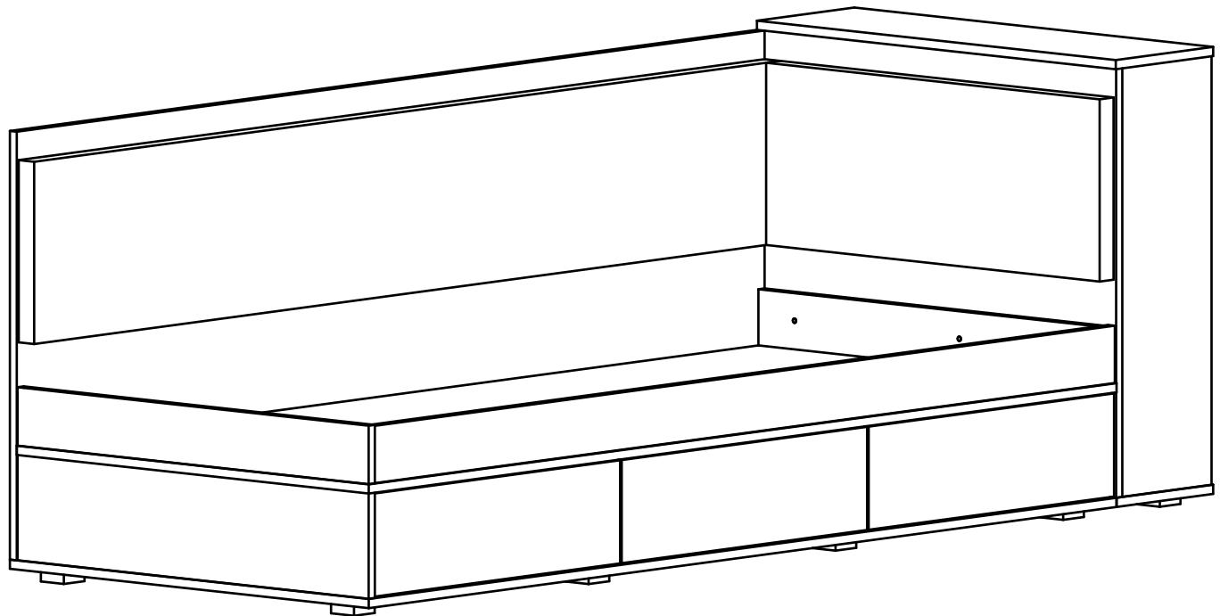
В зависимости от выбранной комплектации возможна зеркальная сборка
