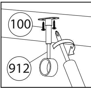
Если штанга-труба длиной более 900 мм – устанавливается проходной держатель
