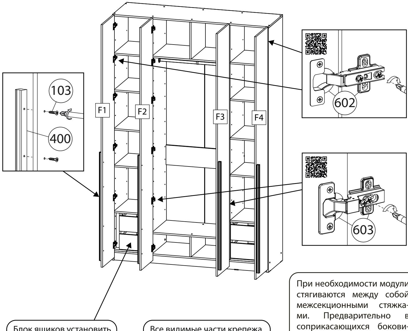
При необходимости модули стягиваются между собой межсекционными стяжками. Предварительно в соприкасающихся боковинах под стяжки просверливаются сквозные отверстия диаметром 5 мм.
