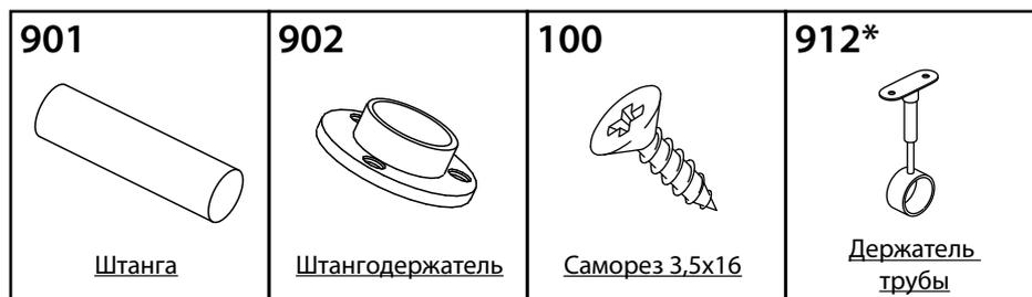
\* Используется только при длине штанги более 900 мм
